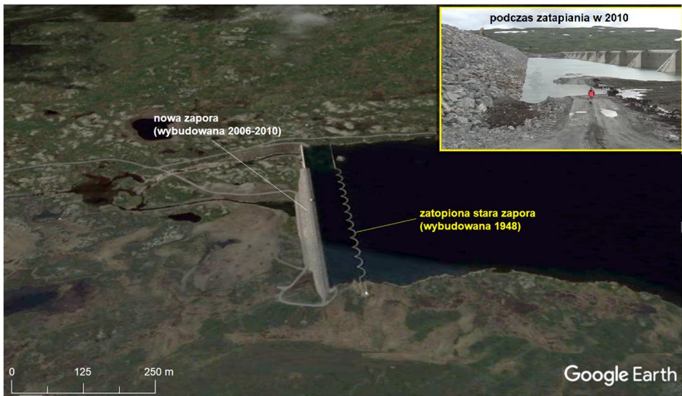
Rysunek 3. Zapora Stolsvatn na rzece Drammen w południowo-wschodniej Norwegii. Stara wielopłaszczyznowa konstrukcja betonowa budowla została zatopiona przez wody spiętrzone nową betonową zapora.
